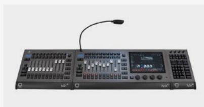
Lichtsteuerung Obsidian NX1 mit optionalen Erweiterungen (Foto: Obsidian Control Systems)
